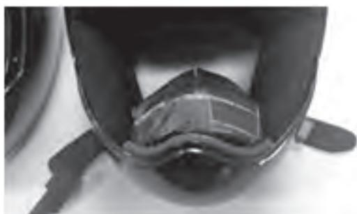
写真1 自作緩衝材をヘルメットに装着した様子
