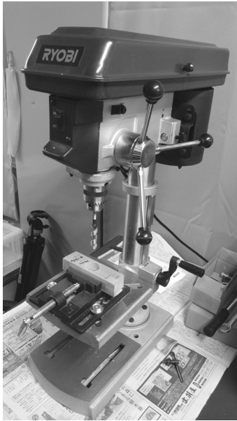
写真5 卓上ボール盤に固定された穴あけ用の木片台
