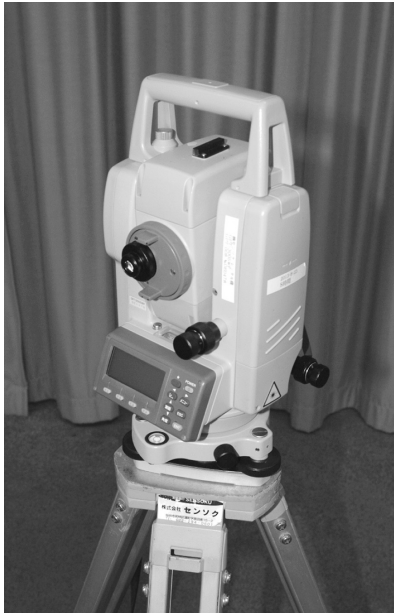
写真 8 コントロールポイントの 3 次元座標値の測 量のために使用したセオドライト (GPT- 3005WF, (株) トプコン)
