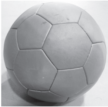
図1 赤外線反射シートで構成されたモーションキャプチャシステム用サッカーボール (32枚パネル).
