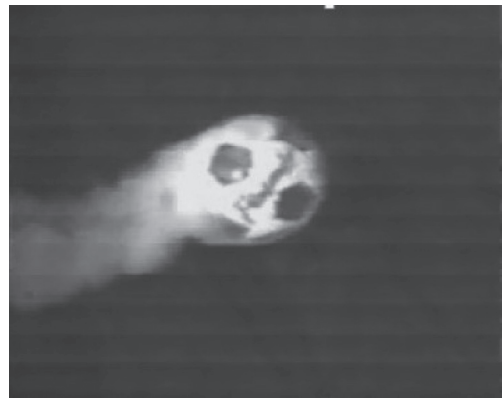
図7 回転して飛翔するサッカーボール後流の渦構造 (27 m/s, 7 rps, 頭頂図) (流れは右から左方向).
